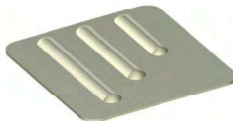
M20 BOMBATURA ASOLA IN CONTINUO DEFORMAZIONE
